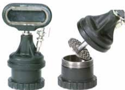
Rysunek 1: Urządzenie do ugniatacia smaru wg ASTM D217
