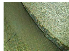
Rysunek 7 Ślady na krawędzi tłoka wskazujące na spalanie stukowe
