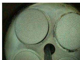
Rysunek 5 Warstwa nagaru popiołowego na głowicy i grzybkach zaworów
