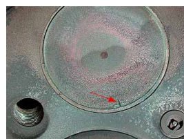
Rysunek 9 Pęknięty zawór
