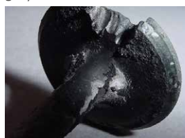
Rysunek 8 Przepalony zawór
