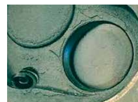
Rysunek 10 Zużyty zawór
